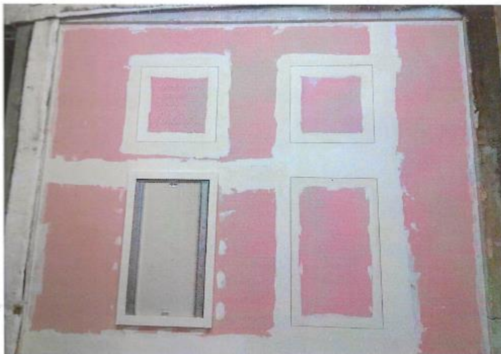
Figura 3 – Lado no expuesto de la muestra a ensayar.
