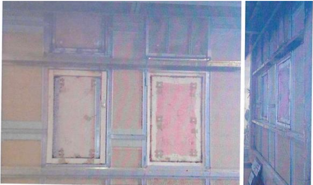
Figura 21 – Lado no expuesto de la muestra ensayada.
