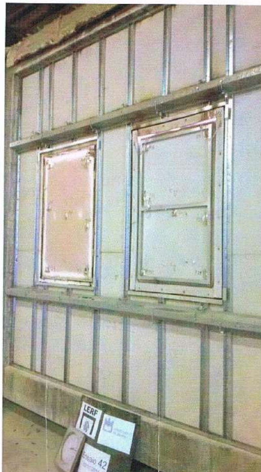
Figura 20. Face não exposta da amostra ensaiada
